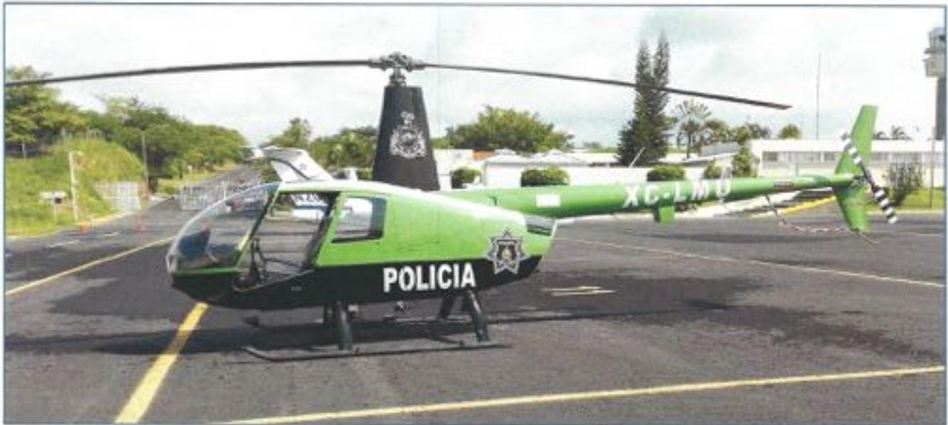
**HELICÓPTERO ROBINSON R44 RAVEN II POLICE, NÚMERO DE SERIE 13180, MATRÍCULA XC-LMU, CON EQUIPO POLICIAL Y MOTOR DE ÉMBOLO LYCOMING IO-540-AE1A5 CON INYECCIÓN DE COMBUSTIBLE, AÑO 2011.**
