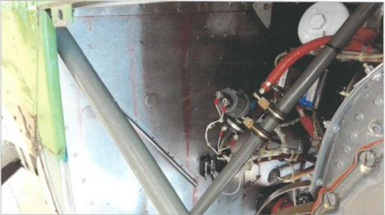
**HUELLAS DE FUGA HIDRÁULICA EN COMPARTIMENTO DE MOTOR**
